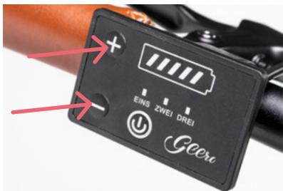
Natürlich kannst du dein Geero auch ohne Unterstützung fahren. Betätige dazu nach dem Einschalten einfach die „-“-Taste – es leuchtet keine der Unterstützungsstufen auf, sondern lediglich die Anzeige des Ladezustandes.
