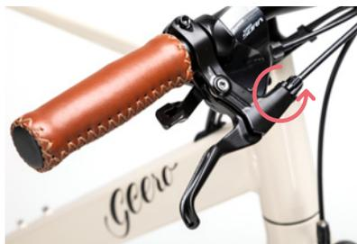
Die Griffweite des Hebels kann an der kleinen Madenschraube justiert werden.
