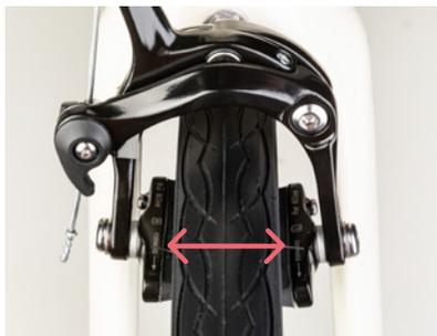
Wenn das Rad montiert ist, drücke den Schnellspanner an der Bremse nach unten! Dieser spezielle Schnellspanner dient der Erleichterung bei der Montage und Demontage des Vorderrades.
