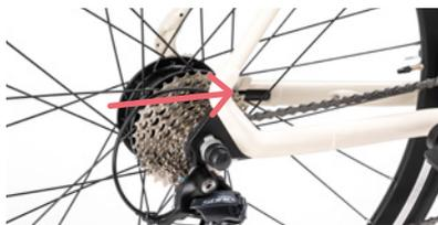
Der Stecker ist wasserfest, deshalb benötigt man etwas Kraft, um ihn auseinander- bzw. zusammenzustecken. Wichtig ist, dass der Motorstecker getrennt wird, bevor das Hinterrad abmontiert wird.
