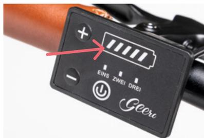
Der Stromverbrauch der Batterie ist linear. Ein Balken entspricht somit 20 % der Ladekapazität. Bitte beachte, dass die Anzeige die Farbe nicht wechselt sondern nur in roter Farbe leuchtet.
